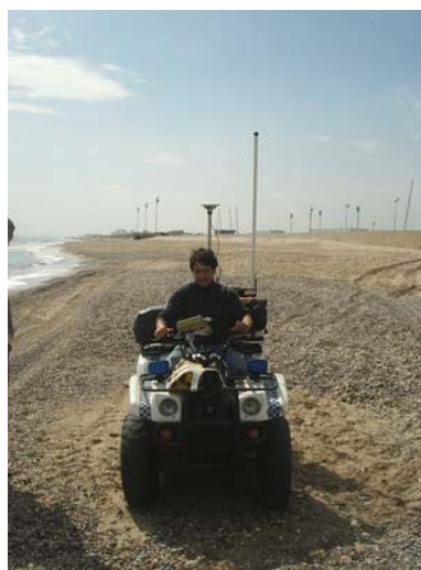
Fig. 2. En la parte derecha se muestra la manera en que se ha instalado el equipo receptor del GPS-RTK sobre el quad que se emplea para medir la playa. En la parte derecha se observa parte de la nube de puntos adquiridos en una de los levantamientos: se puede apreciar perfectamente la trayectoria seguida por el quad.
