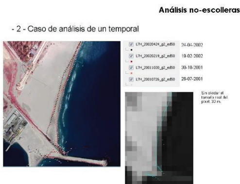
Fig. 2. Líneas de costa obtenidas del sensor ETM+ Landsat 7 antes del temporal (julio 2001, octubre 2001) y después del mismo (febrero y abril de 2002). Se aprecia claramente el impacto del temporal extraordinario que sufrió toda la costa mediterránea española.
