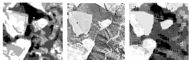
Figura 3 – Detalle de fotografía aérea original (centro) y de las clasificaciones por texturas empleando características derivadas de la MCNG (izquierda) y filtros de energía (derecha). En esta última se ha aplicado el tratamiento post-filtrado para la mejora de las zonas frontera.
